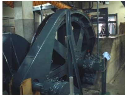
主索輪、直径は3.4mあります。 ロープ太さは32mm
