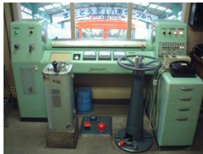
運転台は山上駅に。 左側のレバーがノッチ(速度制御) 右側のハンドルがブレーキ
